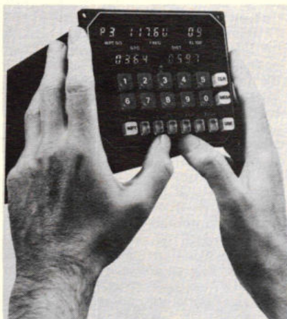
Afb. 46. NCS31 bediening, verwerking en presentatie eenheid met o.a. een MOS-LSI geheugen en presentatie met vloeibare kristallen.
